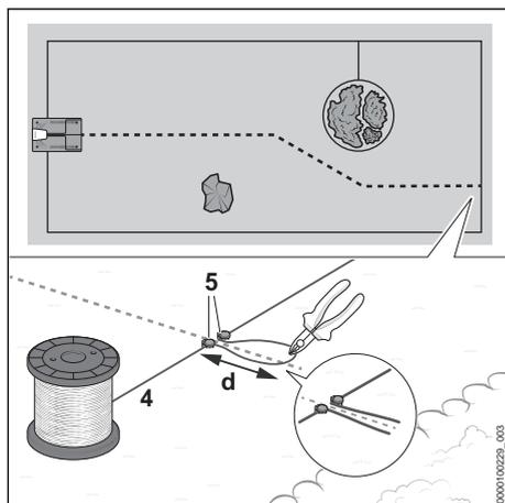
À l'installation du fil de délimitation périphérique (4), il faut configurer le point de raccordement avec le fil de guidage :
