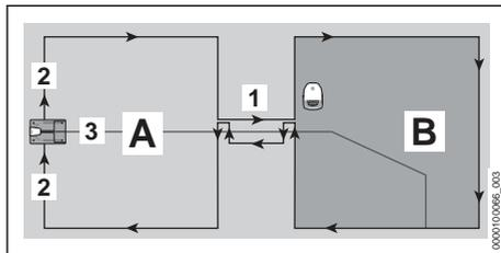
Un couloir (1) permet un guidage ciblé pour traverser des passages étroits ou pour aller d'une surface à tondre à l'autre. Le couloir subdivise la surface à tondre en une surface à tondre principale (A) et une autre surface à tondre (B).
