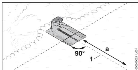
La station d'accueil se trouve en partie sur une plate-bande et en partie sur la surface à tondre, et en partant de la station d'accueil, le fil de guidage (1), peut être amené dans la surface à tondre, en ligne droite sur une longueur  $a = 2$  m.
