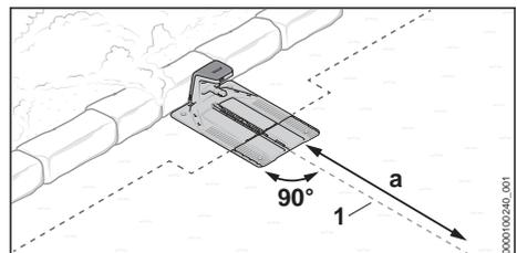
La station d'accueil se trouve sur le bord de la surface à tondre, le long d'un mur et, en partant de la station d'accueil, le fil de guidage (1) peut être amené dans la surface à tondre, en ligne droite sur une longueur  $a = 2$  m.
