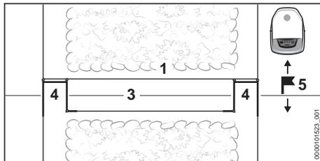
Des boucles de fil (4) signalent au robot de tonte qu'il se trouve à l'entrée ou à la sortie d'un couloir.
