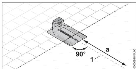
La station d'accueil se trouve en partie sur une surface praticable et en partie sur la surface à tondre, et en partant de la station d'accueil le fil de guidage (1) peut être amené dans la surface à tondre, en ligne droite sur une longueur  $a = 2$  m.
