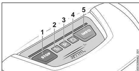
Les fonctions de base du robot de tonte peuvent être commandées à l'aide des touches (1 à 5). L'ensemble des fonctions possibles est accessible via l'application « MY iMOW® ».
