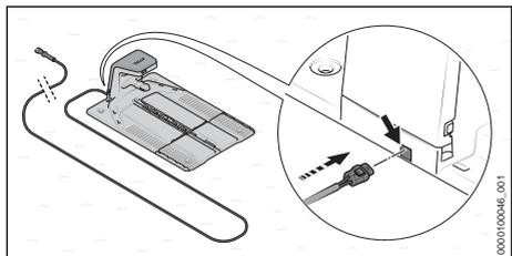
Dans la configuration standard, le câble de recharge peut être branché par l'arrière.
