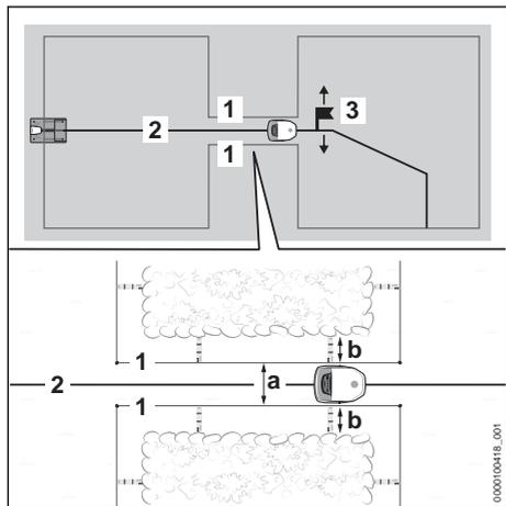
Un fil de guidage (2) assure le guidage précis du robot de tonte à travers un passage étroit, tant qu'un espace minimal (a) est maintenu entre les fils de délimitation (1).
