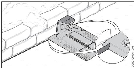
Si la station de base est placée directement contre un mur, le câble de recharge peut être posé sous la plaque de base. Le câble de recharge peut être posé de telle sorte qu'il ressorte de la plaque de base sur la gauche ou sur la droite.
