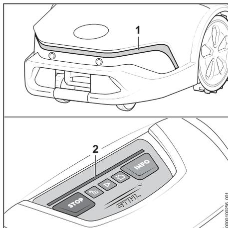
Les bandeaux lumineux (1 et 2) indiquent l'état du robot de tonte et signalent des dérangements.
