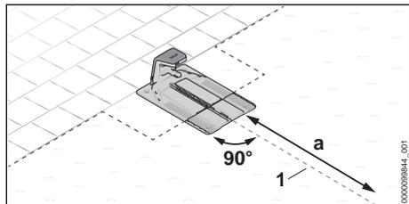
La station d'accueil se trouve sur le bord de la surface à tondre. La surface attenante est praticable et, en partant de la station d'accueil, le fil de guidage (1) peut être amené dans la surface à tondre, en ligne droite sur une longueur  $a = 2$  m.
